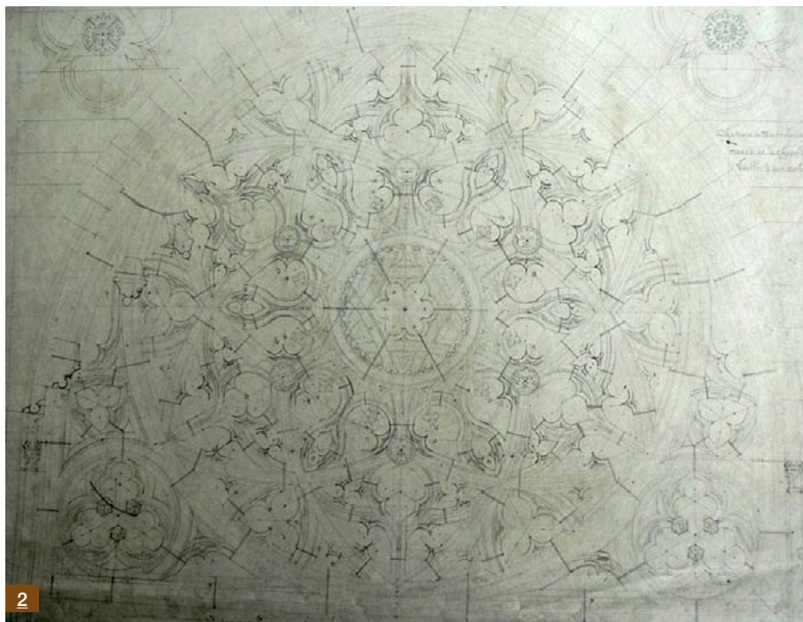
2. Viollet-le-Duc, dessin, 100 goujons en cuivre ont été utilisés pour la grande rosace de la chapelle. Beauvais, Archives départementales de l'Oise : 4Tp 21, Aile des cuisines , juin 1870.
